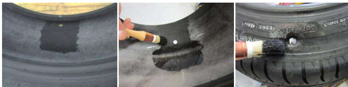
5. Application de la dissolution, à l'intérieur et à l'extérieur du pneumatique.
