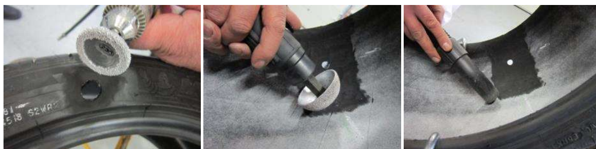
4. Meulage de la zone à réparer et aspiration des poussières.
