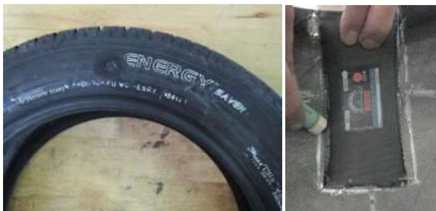
1. Application de l'emplâtre à l'intérieur du pneumatique et traçage et la zone à traiter.
