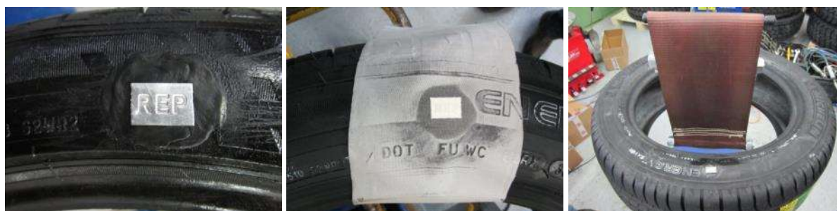
6. Pose d'une plaque signifiant que le pneumatique a été réparé, puis vulcanisation de l'emplâtre.
