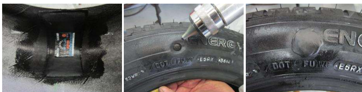
5. Après 20 minutes, application de l'emplâtre et de la gomme de bourrage côté extérieur.
